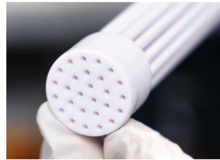
*Keramische Kapillarmembranen mit hydrophober Beschichtung.*
