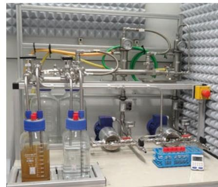
*Technikumsanlage mit Membrankontaktor zum Nährstoffrecycling.*
